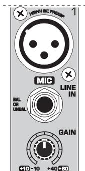
Fig. 2.1: Conexiones y reguladores de las entradas mic/line
